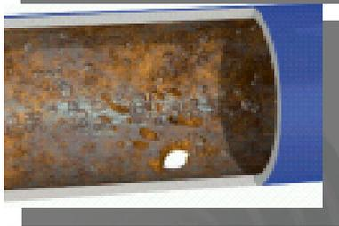
**Corrosioni causate dall'ossigeno presente nell'aria** col conseguente indebolimento, e talvolta anche rottura, di caldaie, tubi e radiatori.
