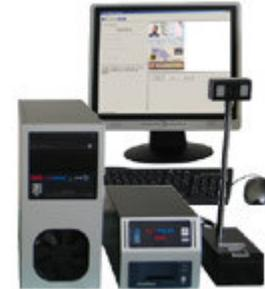
Dal 2001 al 2006 si è utilizzata la modalità **sincrona**: tutte le operazioni (acquisizione dei dati biometrici, personalizzazione del chip, stampa della banda ottica e del supporto plastico, emissione dei PIN) in una unica sessione.
