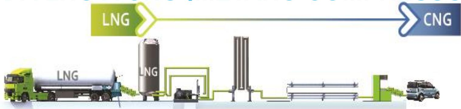
Questo tipo di stazione di rifornimento è la più comune in Italia. Il GNL, attraverso un impianto specifico, viene convertito allo stato gassoso e infine compresso in modo da poter rifornire i veicoli. Adatto per:
